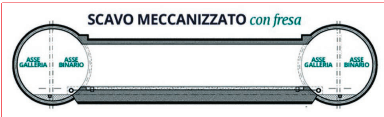
Fig. 3 - Tipologico gallerie con scavo meccanizzato (sito web https://www.terzovalico.it )
