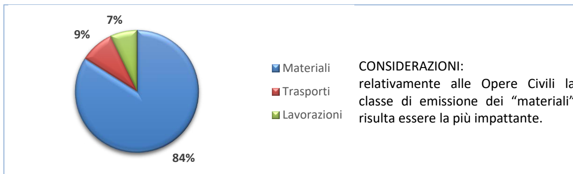
Figura 12 Grafico: Emissioni originate dalla realizzazione delle Opere Civili
